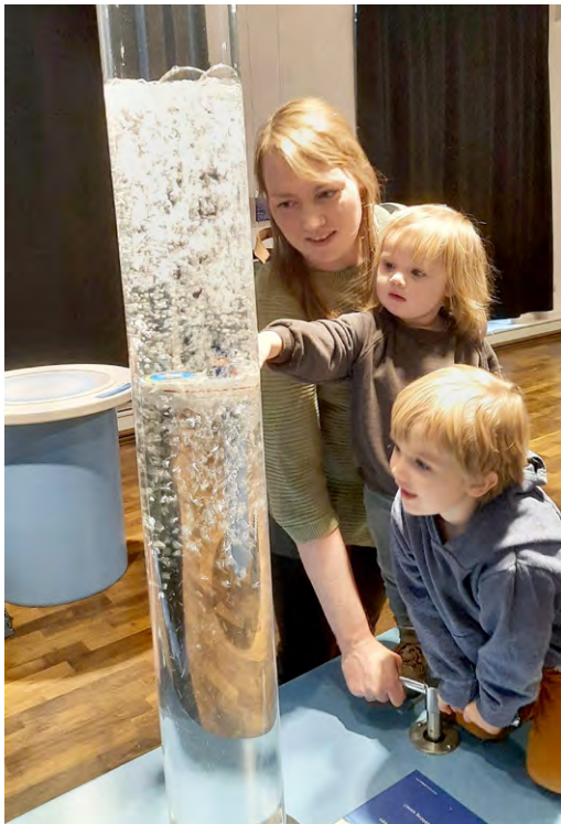
Aufsteigende Luftblasen, von den Besucher:innen selbst erzeugt, bringen ein Schiff zum Sinken.
